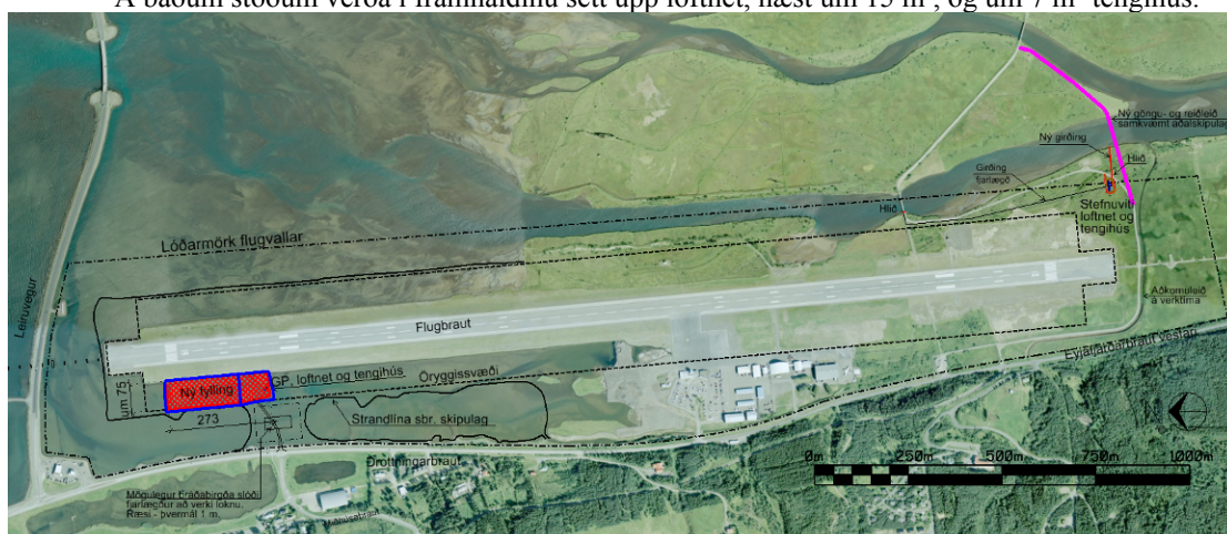
Mynd 2 Yfirlit yfir Akureyrarflugvöll og fyrirhugað framkvæmdasvæði. Ný fylling rauðmerkt.
