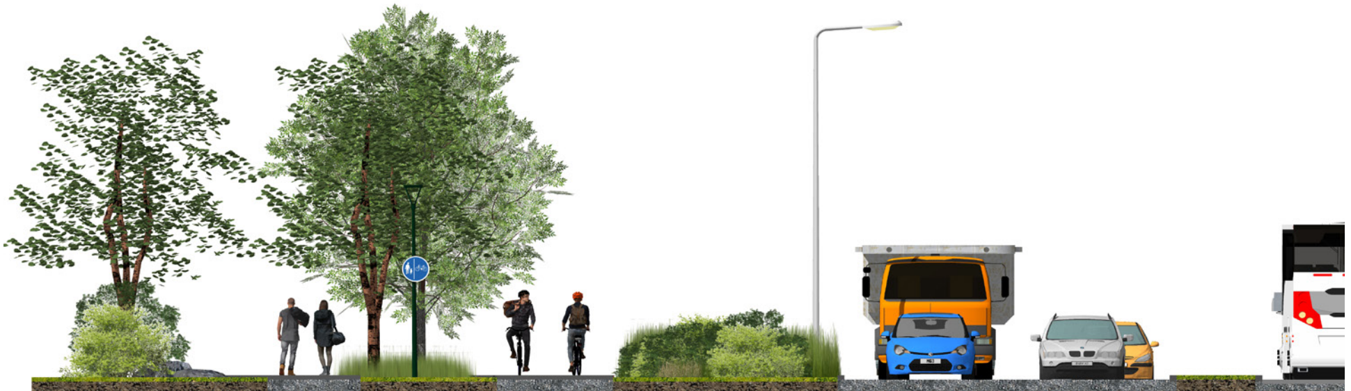
Mynd 31.20 Snið af C gerð stofnstíga með aðskildum göngu- og hjólastígum. Gróðurbelti aðskilur stígana frá umferðarpungri götu.
