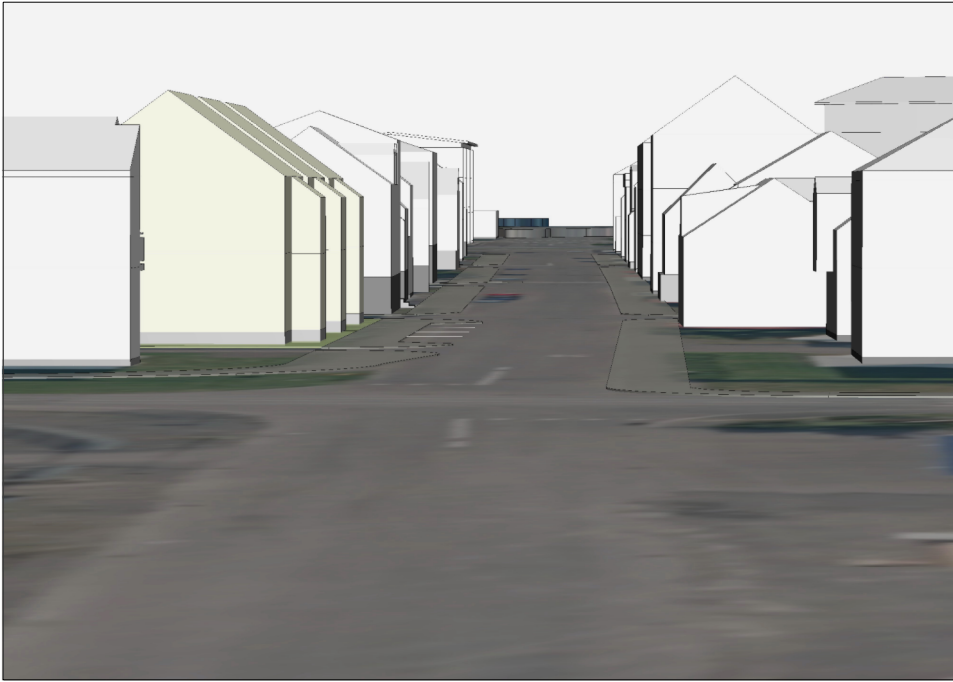
Horft vestur Gránufélagstötu. Mænishæð 8,8 m.
